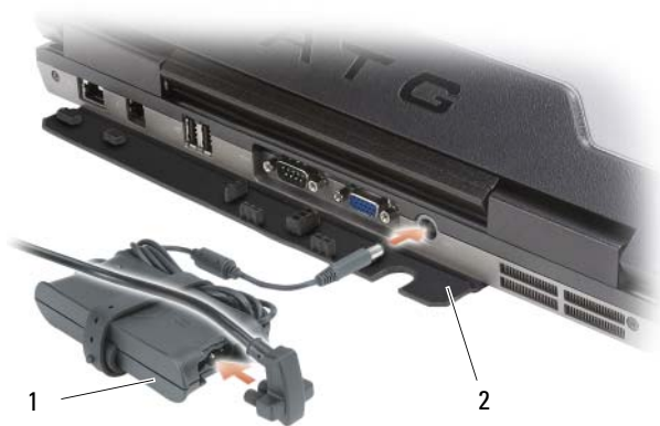
1 交流電變壓器
